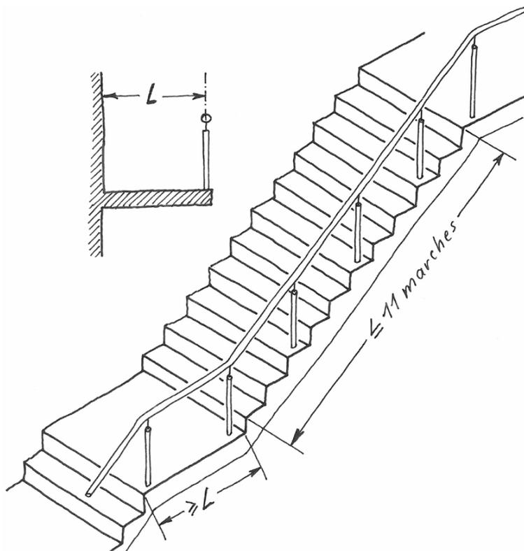
La largeur d'un escalier ou d'un palier et la profondeur d'un palier se mesurent à la hauteur de la main courante entre les axes des mains courantes ou entre l'axe de la main courante et le nu du mur opposé.
